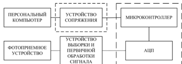
Рис.5. Сопряжение КИА и ПК
