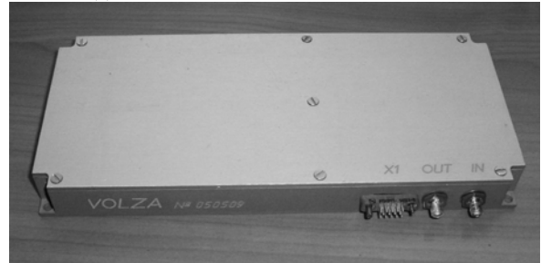
Рис.3. Общий вид базовой конструкции ВОЛЗА, рассчитанной на задержку сигнала до 2 мкс
